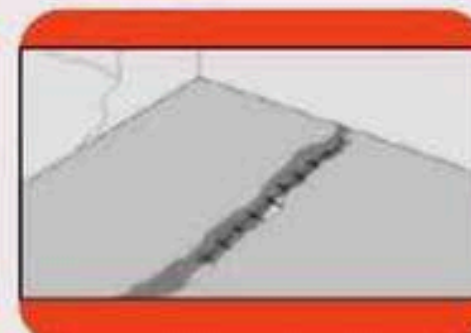
รอยแตกร้าว > 5 มม. กว้างจนเห็นเหล็กเสริม
