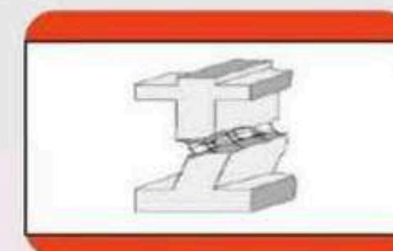
ผนังแตกหักหรือร้าวผิดปกติมากกว่า 2 มม. มีการปริแตกของคอนกรีตเป็นบริเวณกว้าง จนเห็นเหล็กเสริมได้อย่างชัดเจน
