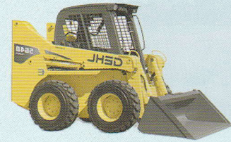
스키드로더 skid-steer loader 스키드로더로 폐기물을 치웁니다. Clear up waste matter with a skid-steer loader.
