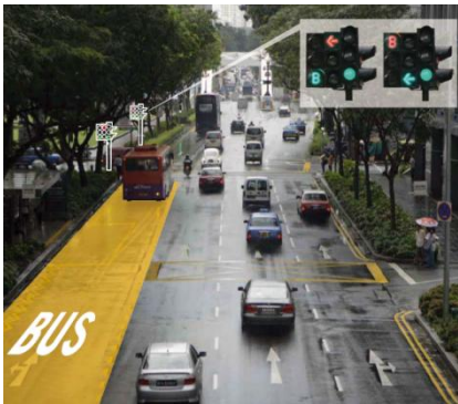
รูปที่ 10 การให้สิทธิ์สัญญาณไฟแก่รถเมล์บริเวณสี่แยก
